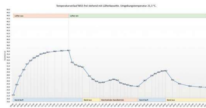
Bild 6: Temperaturverlauf mit und ohne Lüfter bei verschiedenen Betriebszuständen des Tonbandtransports
