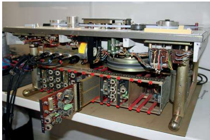
Bild 11: Frontansicht »M15« mit demontierten Blenden und eingebauter Adapterplatine
