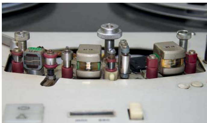
Bild 3: Tonkopfbücke Telefunken M15 mit internationaler Schichtlage
