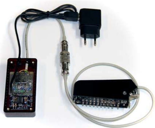
Bild 10: Fernbedienung mit Treiberstufe und Relais (Gehäuse geöffnet), mit Netzteil und Steckverbinder
