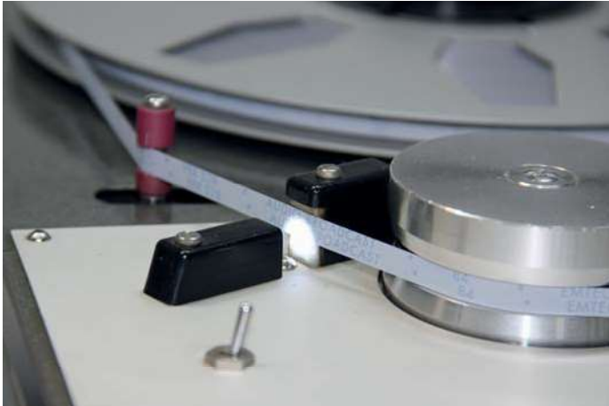
Bild 14: Lichtschranke im aktiven Modus
