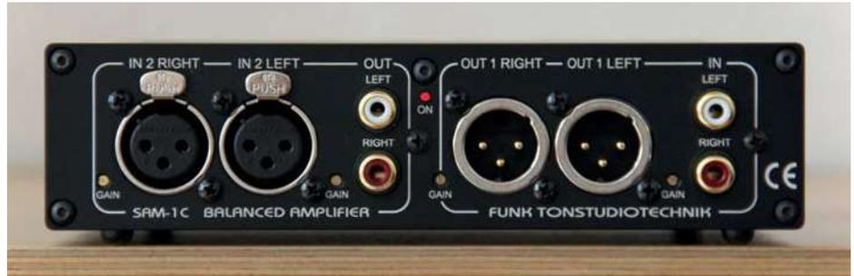
**Belastung von Eingängen nachfolgender Geräte und/oder Einflüssen durch Audiokabel mit hohen kapazitiven Werten vor.** Durch diese Maßnahme kann eine Verbesserung des Tiefbassverhaltens – inklusive verringerter Phasenabweichung, auch im hohen Frequenzbereich – erreicht werden. Im oben genannten Anwendungsfall ist die beste Lösung, den »SAM-1C« am Ende der langen symmetrischen Leitung anzuschließen und dann mit einem kurzem Cinchkabel auf den Verstärker zu gehen.
