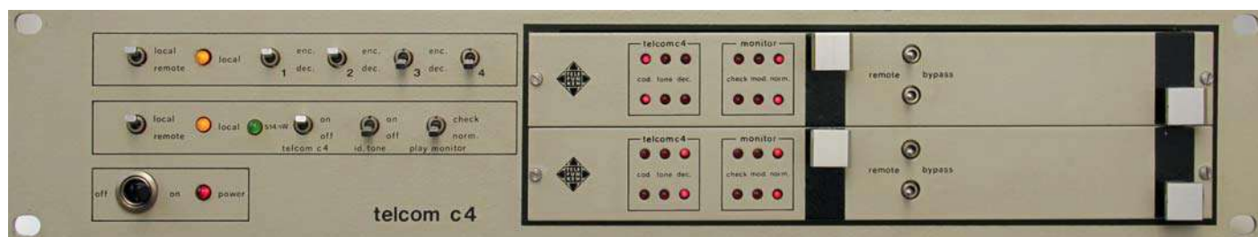
Bild 1: Telefunken Einschubträger ES 4 mit 2-Kanal-Kompandereinschub telcom c4 F2H (2 Stück)
